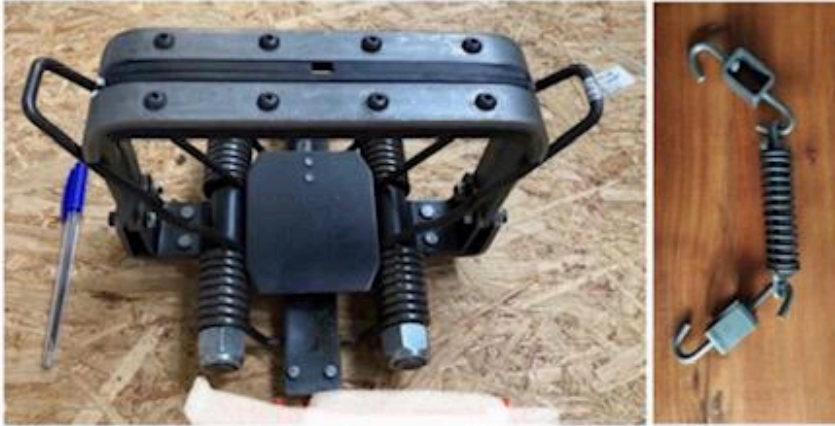
Figuur 7 Klemval met rubberen kussens van het type Bridger #9 (links, links), schokabsorberende veer (rechts).
